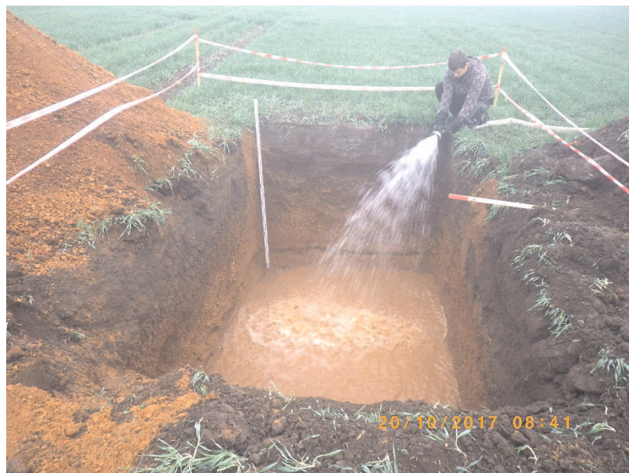
Foto 4. Kopaná sonda KS1 během napouštění. Druhá velkoobjemová zasakovací zkouška ze dne 20.10.2017.
