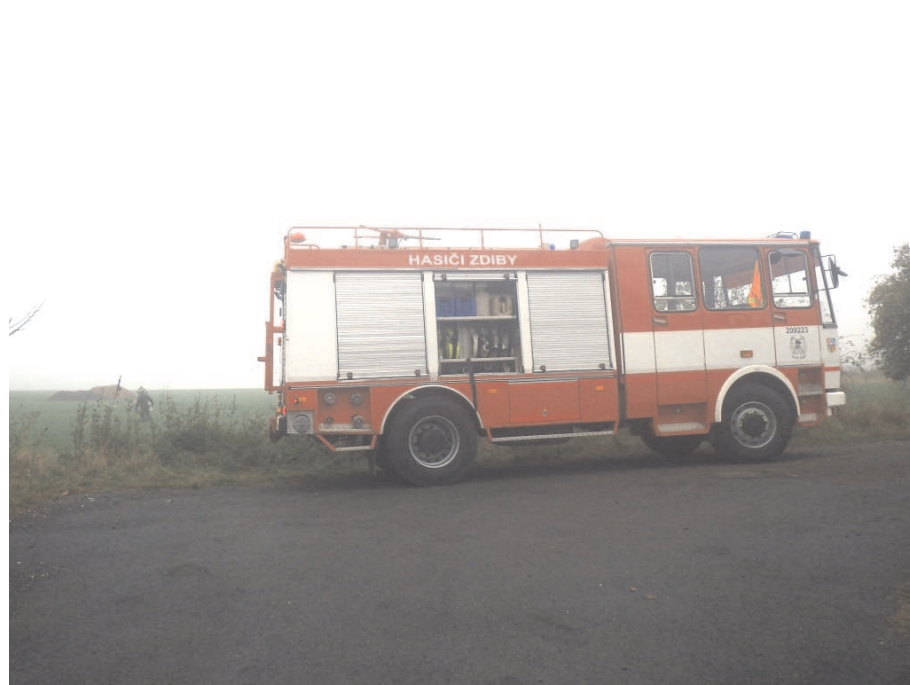
Foto 1. Hasičská cisterna sboru dobrovolných hasičů ze Zdib využita pro velkoobjemovou zasakovací zkoušku.
