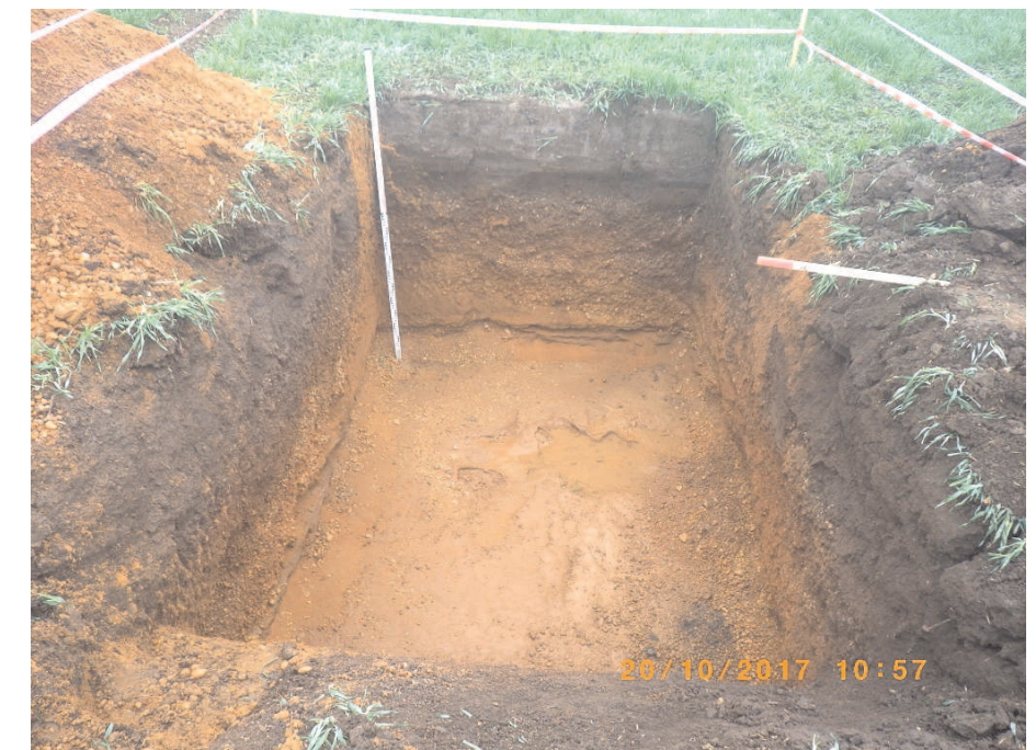
Foto 6. Kopaná sonda KS1 po úplném zasáknutí 2500 l vody. Konec druhé velkoobjemové zasakovací zkoušky ze dne 20.10.2017.
